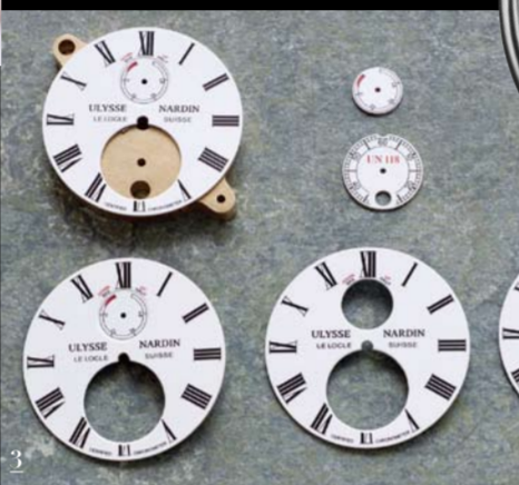
1 금속 실로 형태를 만든 후 에나멜을 채우는 신마리코 시계 다이얼, 올리브 나르덴. 2 페르메이르의 진주 귀조리를 한 소녀를 그리는 에나멜 재현했다. 예가르르르. 3 그랑 외 다이얼에 인텍스를 넣는 과정, 올리브 나르덴. 4 그랑 외 방식으로 구운 화이트 다이얼 위에 한자 달력을 그린 빌레 트레비신 차이나즈 캘린더 시계, 블랑팡. 5 블랙 에나멜 그린 뒤 그 위에 리모주 화이트 칼라를 덮고, 이를 송곳으로 구멍내어 바탕의 블랙이 드러나도록 하는 그리자유(grisaille) 에나멜 방식으로 오리안을 묘사한 로몽드 드 카르피에 시계, 카르피에.
